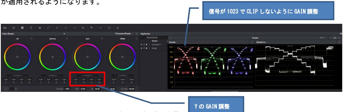
Fig.37 DaVinci Dynamic Range 800%を CLIP させない調整
